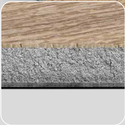
Denscore PRO rdzeń mineralny wytwarzany w procesie wytlaczania z węgla wapnia i dodatków uszlachetniających; grubość: do 4,5 mm
